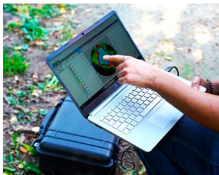
Analiza raportu szczegółowej diagnostyki wybranego drzewa z wykorzystaniem tomografu akustycznego (fot. A. Błaszczuk)
